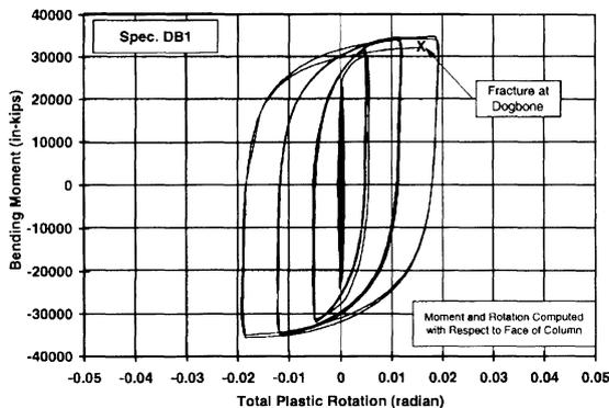
Fig. 2. Specimen DB1.
