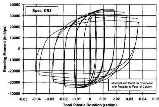
Fig. 4. Specimen DB3.
