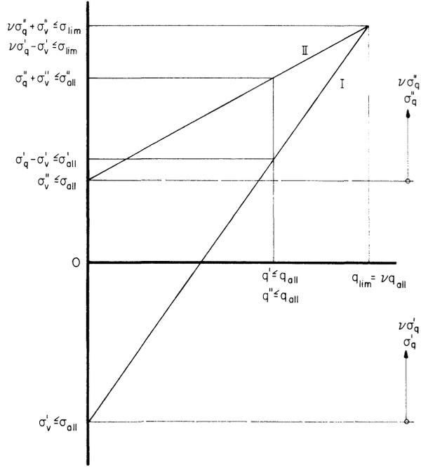
(d) ANALYSIS OF PRESTRESSED STRUCTURES ACCORDING TO FRITZ'S METHOD.
